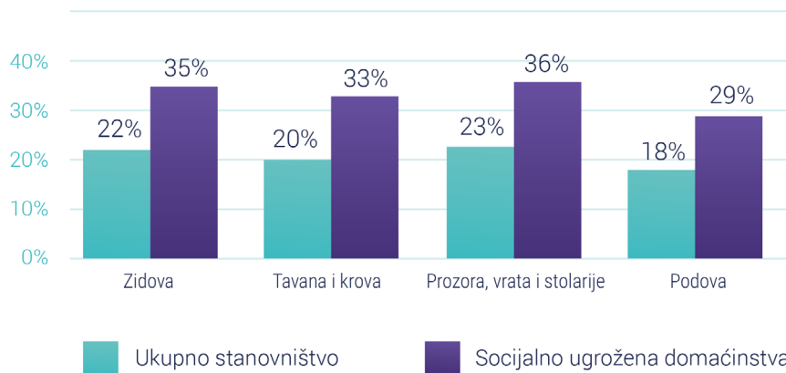
Ilustracija 15 Razlika između udela ukupnog stanovništva i socijalno ugroženih domaćinstava koja su ocenila kvalitet toplotne izolacije više elemenata sopstvenog stambenog objekta kao loš i veoma loš
